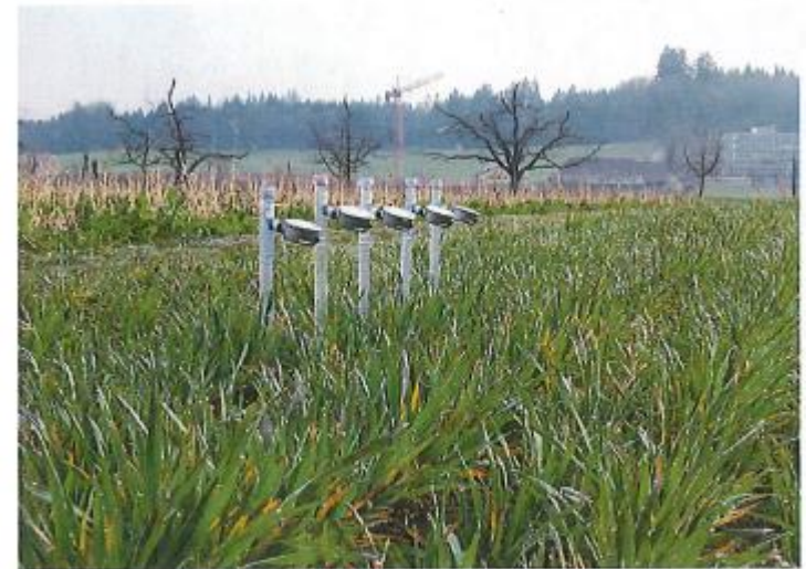
Abbildung 10-1: Tensiometermessstation mit Handablesung: Der Medianwert von jeweils fünf Tensiometern erfasst die Heterogenität des Bodens.
